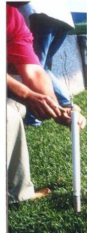
Mise en place d'un dispositif de sondes tensionométriques sur site
